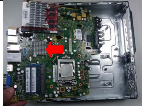
c) Remove PCA from chassis
